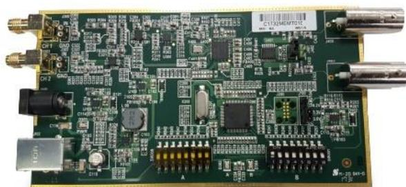
Keysight AE6950A 分频器板用于包含干扰信号的失真测试。
