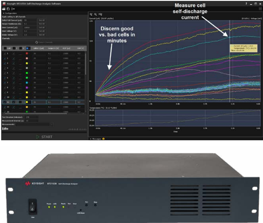
图 6. 是德科技的恒电位测量技术 可以缩短判断电池自放电性能好坏所需的时间
